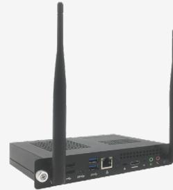
PC slot-in connesso al monitor tramite singola interfaccia, integrato perfettamente nel monitor.
